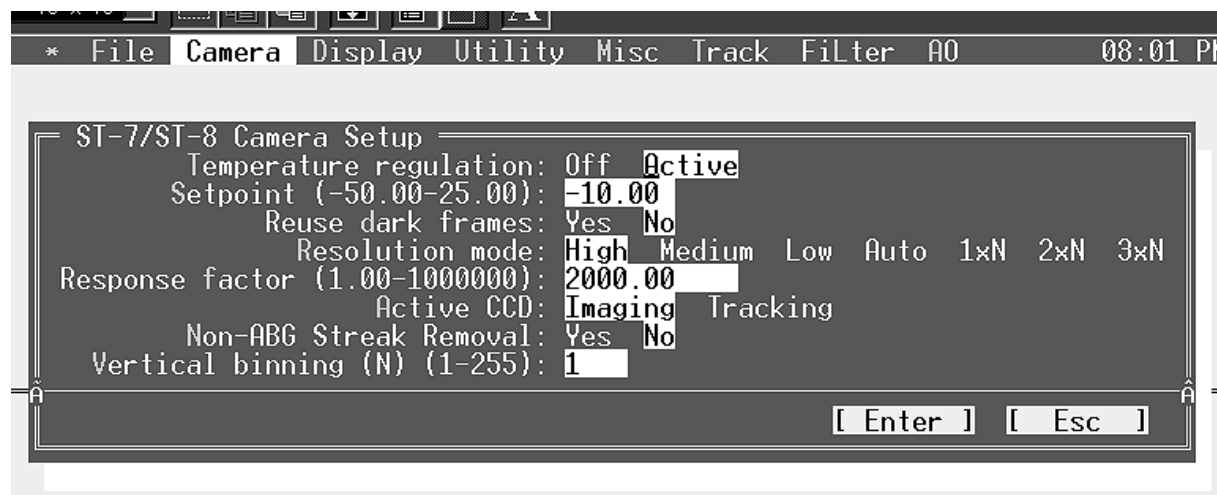
Setup Kommando im Kamera Menü zum Einstellen des Resolution Mode (Binning)
