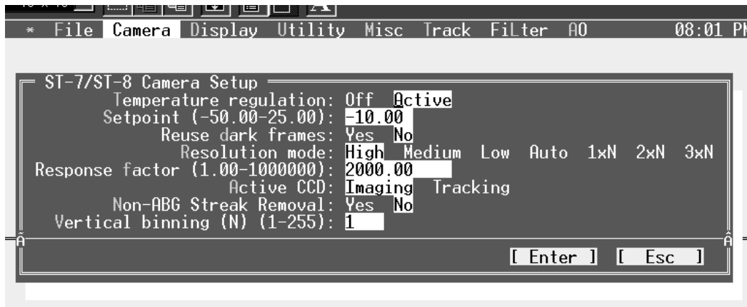
Camera Setup im Camera Menü zur Temperaturkontrolle
